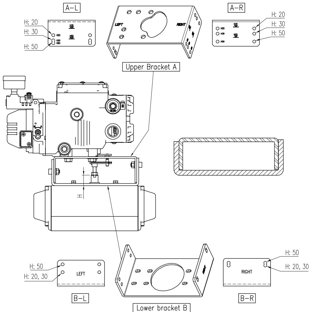
그림 3-13: 액츄에이터 스템 높이 H의 종류에 따른 브라켓 조립 방법
