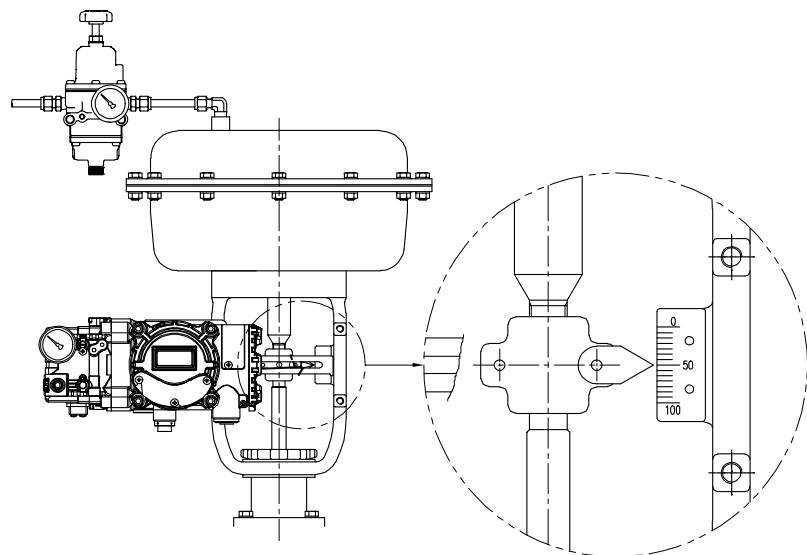
그림 3-6: 공압레귤레이터를 액추에이터에 직접 연결하여 50 % 스트로크에 위치시킨 모습
